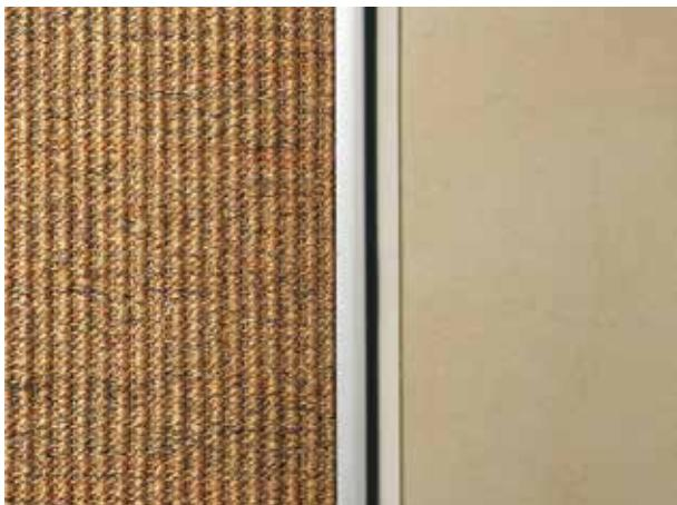
STRIPTEC schützt wirksam den Übergang von gleichhohen Bodenbelägen. Die abgerundete Oberfläche ermöglicht den Ausgleich von geringen Höhenunterschiede bis zu 5 mm. Das Anbringen des profils erfolgt nach der Verlegung der Beläge. Somit können Fugen, Kanten und Beschädigungen überdeckt werden. STRIPTEC ist selbstklebend und gebohrt, in den Ausführungen Messing poliert, Edelstahl oder Aluminium eloxiert erhältlich.
